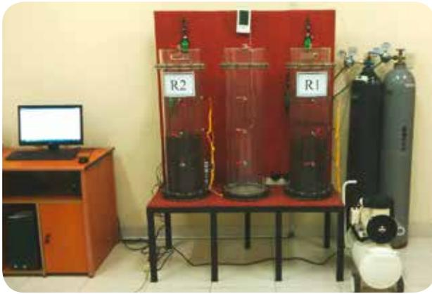
P 213: Abb. 3: Reaktoren zur Untersuchung des Methanoxidationspotentials von verschiedenen Komposten – Versuchsreihe 2 / Fig. 3: Reactors for the examination of the methane oxidation potential of different composts – test series 2
