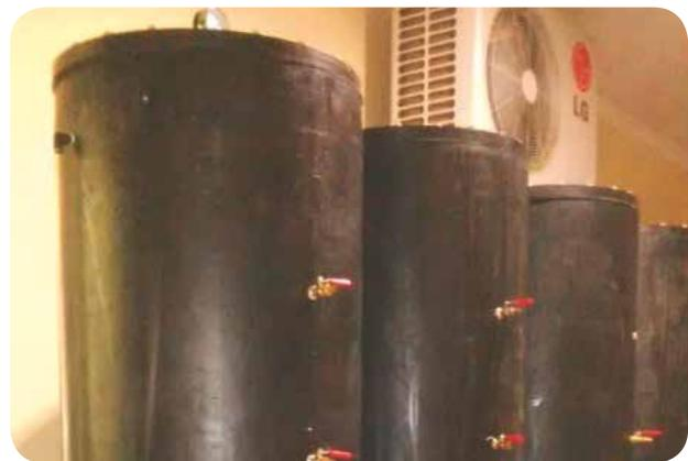
P 213: Abb. 2: Deponiereaktoren (Rohmodelle) zur Untersuchung von Hausmüll – Versuchsreihe 1 / Fig.2: Landfill reactors (raw models) for examination of household waste – Test series 1
