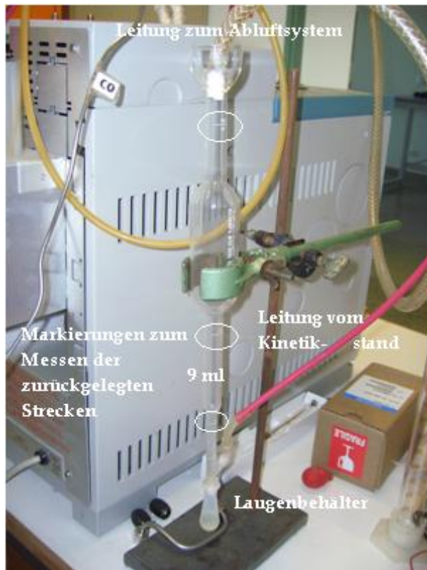
Abb. 15: Bubblemeter des Kinetikstandes im IMC mit Voluminamarkierungen und Leitungen
