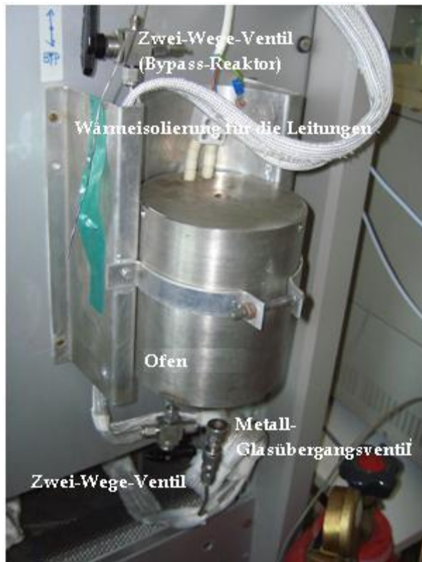
Abb. 12 : Ofen des Kinetikstandes am IMC, mit allen zugehörigen Leitungen und Ventilen
