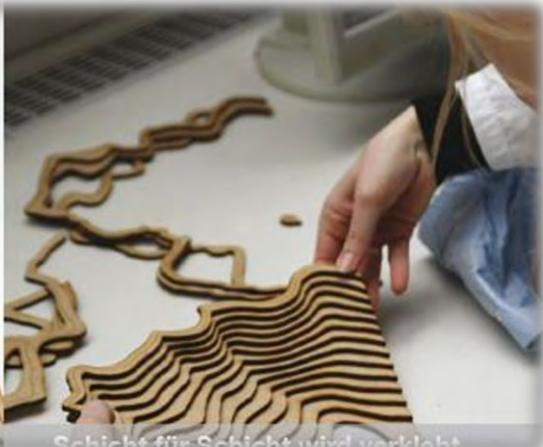
Schicht für Schicht wird verklebt
